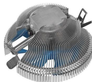
Рисунок 4 Радиатор из наборных пластин радиального типа ( не подходит из-за быстрого засорения пылью ):
